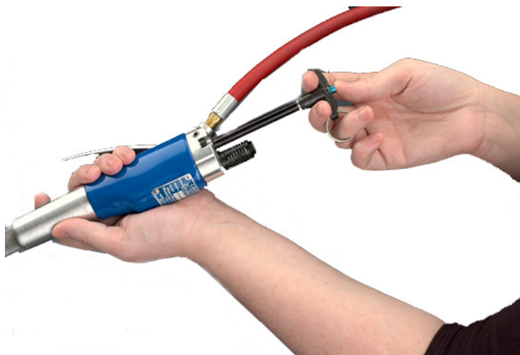
FIGURA 2 AJUSTE DEL RECORRIDO PARA DIFERENTES LONGITUDES DE TORNILLOS
