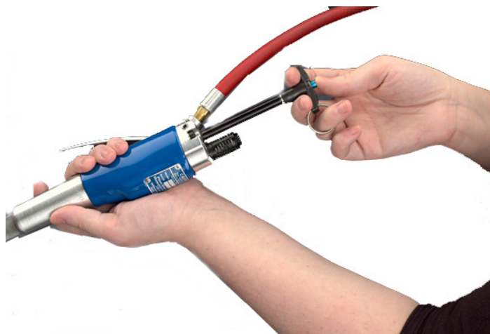
ABB. 2 EINSTELLUNG DES WERKZEUGHUBS FÜR UNTERSCHIEDLICHE SCHRAUBENLÄNGEN
